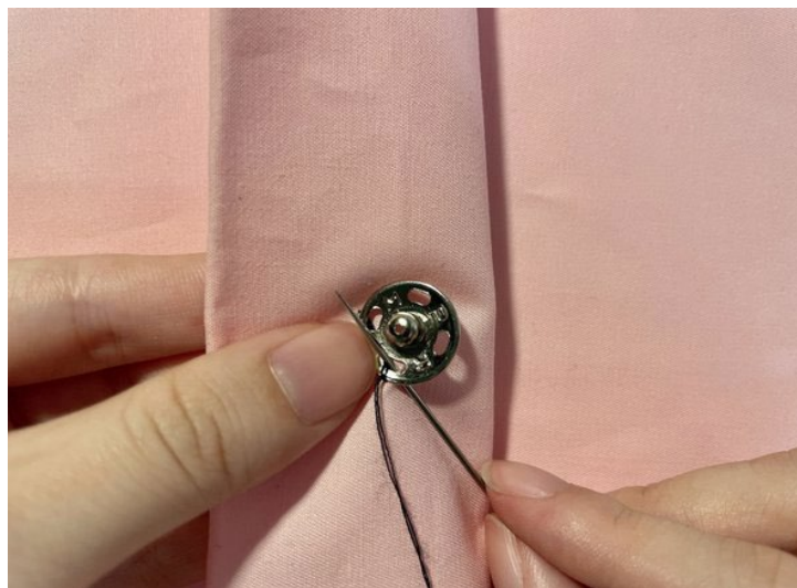
Fig. 7.68: Continue sewing press stud
